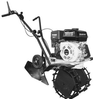
Обработка почвы окучником подразумевает два вида операций. Это либо нарезка грядок, либо окучивание уже нарезанных грядок.
